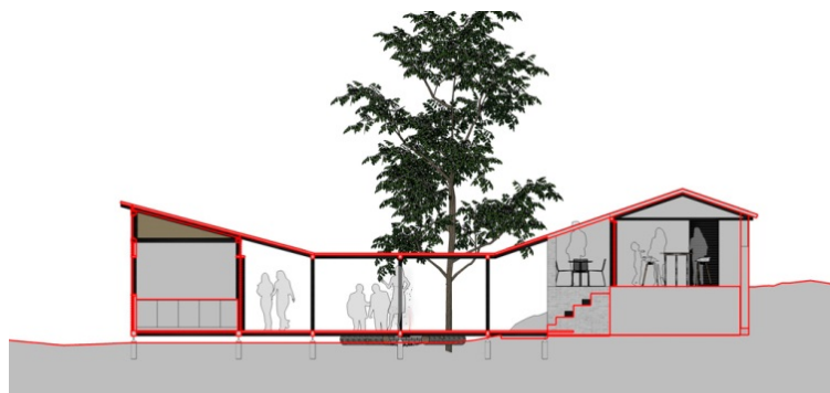
Principsnit gennem hønsehuset til højre og service-containeren længst til venstre, samt pergolaen mellem husene og langs servicefunktionerne.
